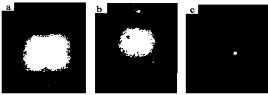
图 12 NCH 的小角激光散射图 a-尼龙 6; b-尼龙 6/未处理粘土; c-NCH
